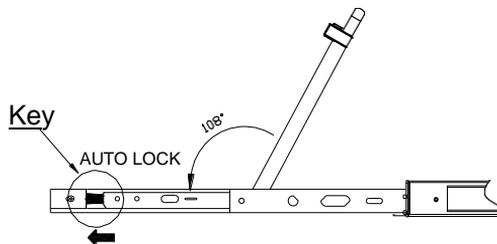
图 3-5 控制平台滑轨解锁方式
