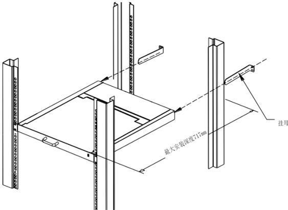
图 2-1 机架安装图(一)
