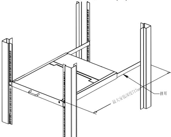
图 2-2 机架安装图(二)
